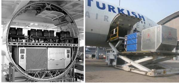
Resim 5: ULD (Unit Load Devices) – Birim Yükleme Gereçleri
