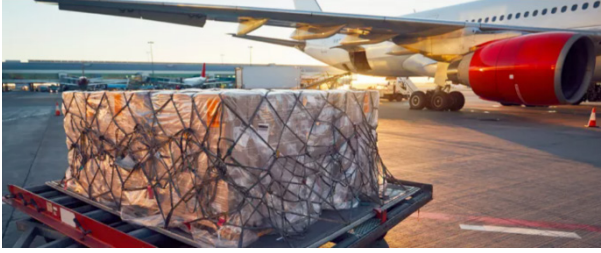
Resim 4: Kargo Yüklerinin Paletlenmesine Bir Örnek
